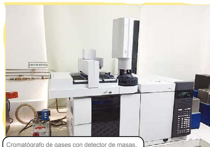
Cromatógrafo de gases con detector de masas.
